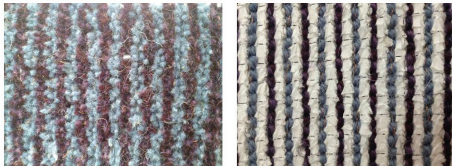
图4 U型立绒3D FSF样品正面(左)、反面(右)
