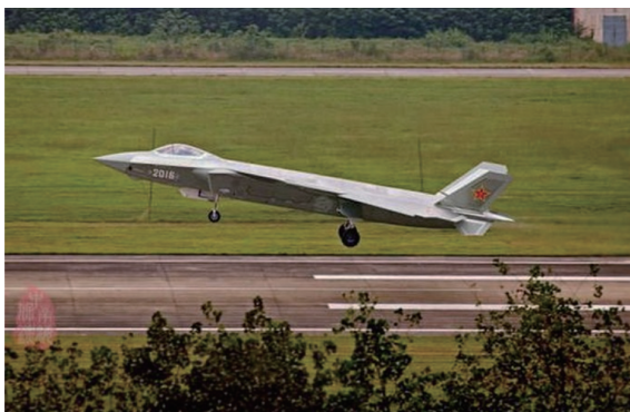
目前歼-20采用的仍是传统隐身涂层技术,只能吸收特定波段的雷达波,与美国F-22、F-35的涂层技术属同一代产品
