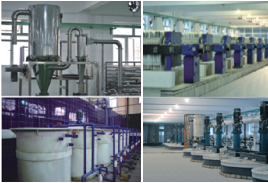
图 11 年处理 1 万 t 含砷废渣无害化脱砷湿法中试生产线
