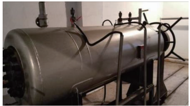
图7 150 L燃烧合成高压氮化炉
