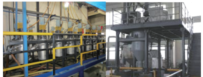
图9 金精炼离心萃取及合金水淬雾化生产线
