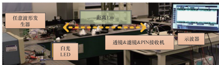
图8 采用双级联双级联桥T均衡器的白光VLC实验装置
