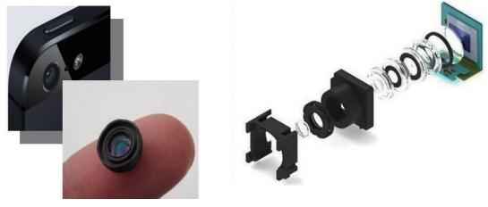
图13 微镜头及MEMS镜头的基本结构
