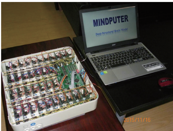
图4 世界上第一台深构造脑模型(Mindputer),由36个多丛异分处理器组合设计而成,可生成许多种深构造网络
