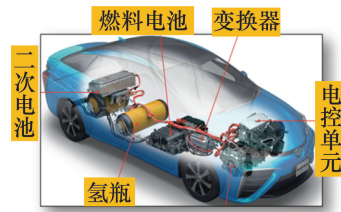
图4 燃料电池动力系统车上布局
