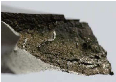
图3 裂纹横断面宏观形貌 Fig. 3 Morphology of crack transverse
