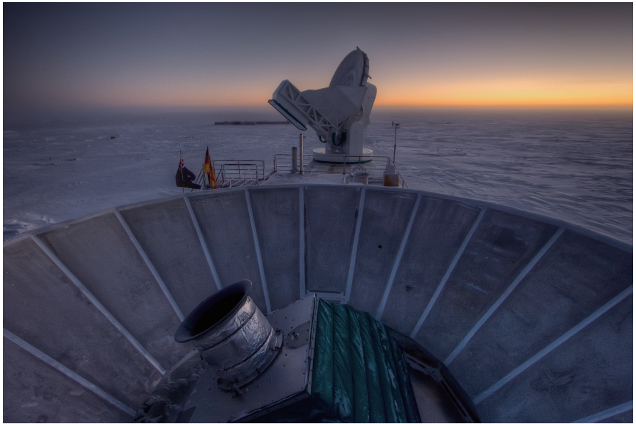
图5 位于美国南极极点观测站的BICEP2望远镜(背景是10 m的南极望远镜),两架望远镜在不同的空间分辨率观测宇宙微波背景辐射,是迄今为止最好的地面观测实验。
