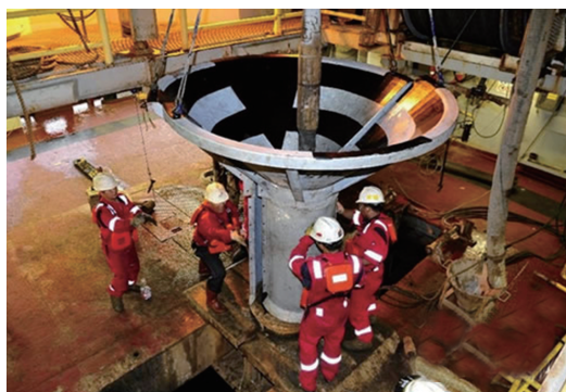
图13 “决心”号钻探人员在通过船底与海水相连通的月池上安装返孔锥(图片来源:新华网)
