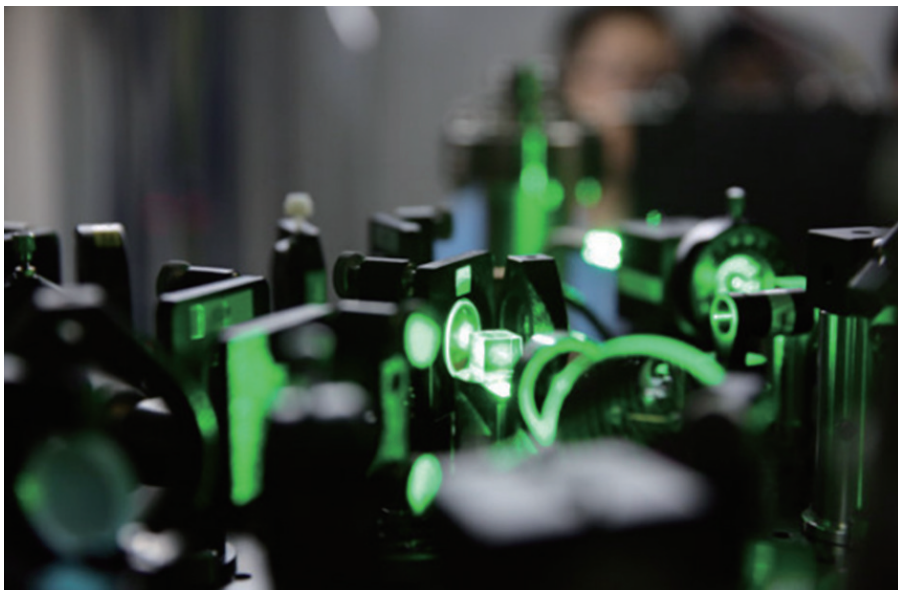
图17 中国科学院-阿里巴巴量子计算实验室-plug光路,用于囚禁原子 (图片来源:TechWeb.com.cn)
