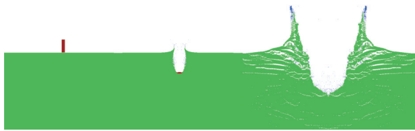
(a) 开始接触 (b) 弹体完全破碎 (c) 最终弹坑
