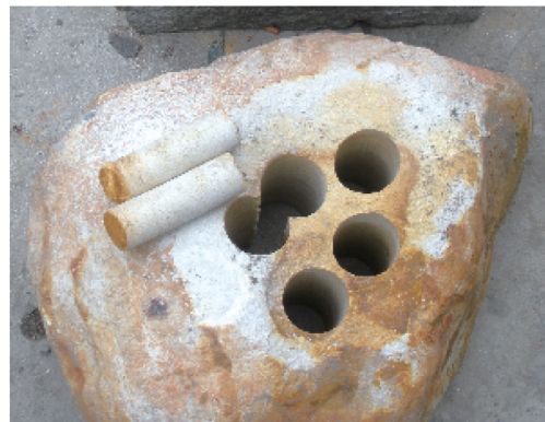
图7 钻头开刃用岩样
