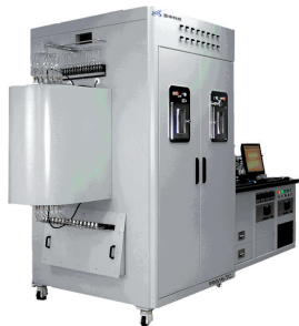
图22 亚申科技PRS-16多通道高通量反应器系统
