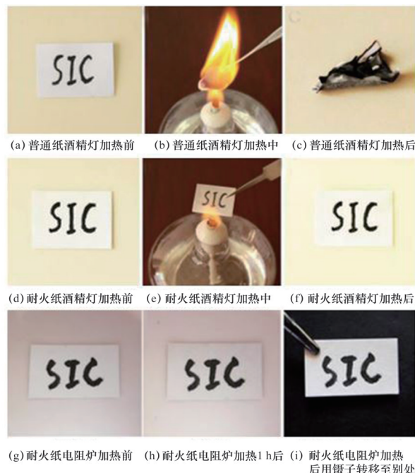
图中字体由毛笔蘸石墨的乙醇分散液书写而成
