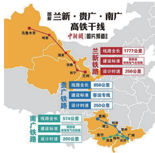
图21 中国3条重要高铁干线——兰新高铁、贵广铁路、南广铁路示意(图片来源:中国新闻网)
