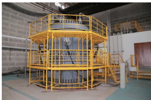
图10 主氦风机顶部(图片来源:清华大学核能与新能源技术研究院网)
