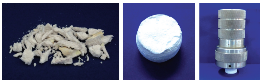
(a) 化学提纯的麦秸秆纤维素 (b) 纤维素气凝胶 (c) 受压状态下的纤维素气凝胶
