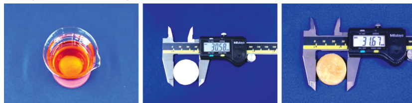
(a) 吸油状态 (b) 吸油前尺寸测量 (c) 吸油后尺寸测量
