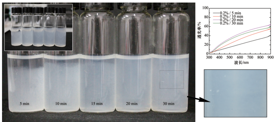
图1 不同均质处理时间得到的质量分数0.2%CNF在水相介质中的分散效果
