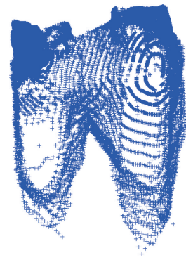
图 3 复杂采空区的点云模型
