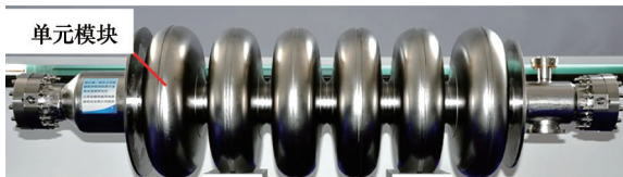
图1 6单元中 \beta 射频超导腔
