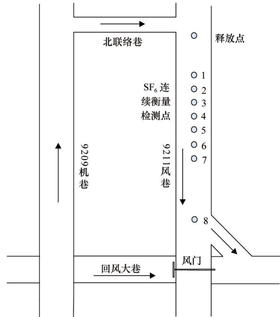
图3 9211 风巷释放点与检测点布置示意
