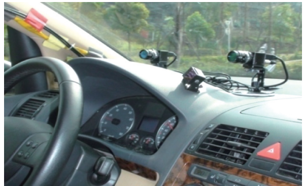
图1 faceLAB 5视觉追踪仪安装位置
