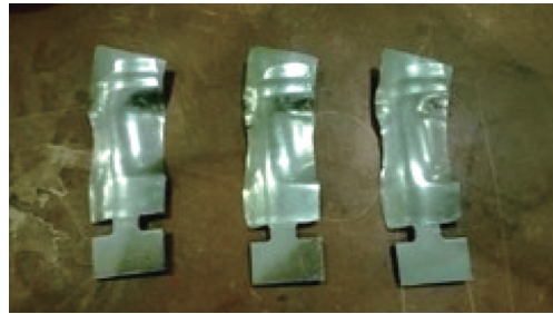
图14 叶片轧制试验结果
