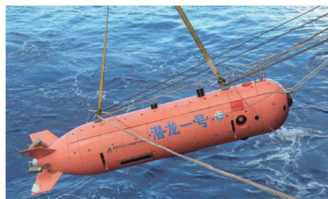
图15 中国“潜龙一号”水下无人无缆潜水器(图片来源:中国网)
