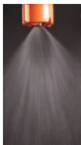
图4 二流体雾化喷嘴喷雾效果 Fig. 4 Air atomization nozzles
