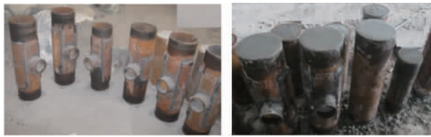
(a) 空钢管 (a) Empty steel tube (b) 浇注后试件 (b) Poured specimen
