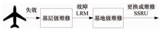
图 4 两级维修体制的简单维修流程 Fig. 4 Simple maintenance procedures of two-level system
