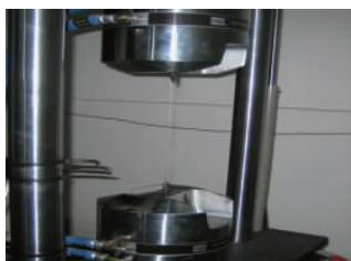
图3 模拟钢筋抗拉试验
