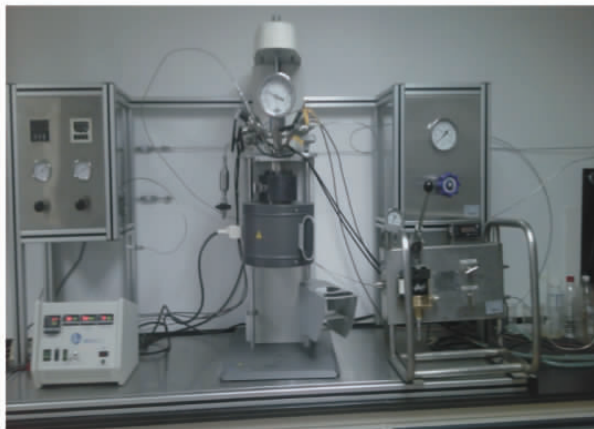
图2 水-岩-CO 2 反应实验装置流程及实物
