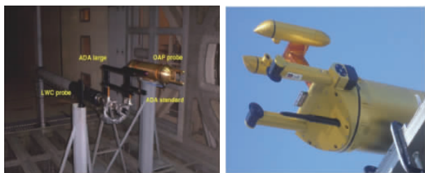
(a) 冰风洞中的 OAP 测量仪 (a) OAP probe in the tunnel (b) CCP 组合测量仪 (b) Cloud combination probe
