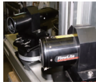
图 5 PDPA 粒子分析仪 Fig. 5 Phase doppler particle analyzer
