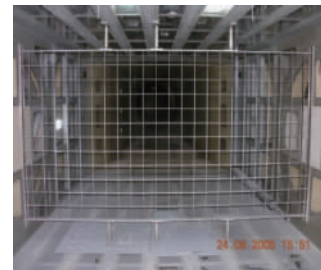
图 6 安装在冰风洞中的格栅 Fig. 6 Grid fixed in the tunnel
