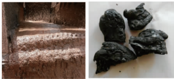
图 2 稠化封闭后返出的稠油沥青
