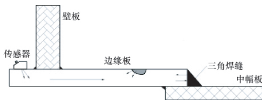
图 1 储罐底板缺陷超声导波检测
