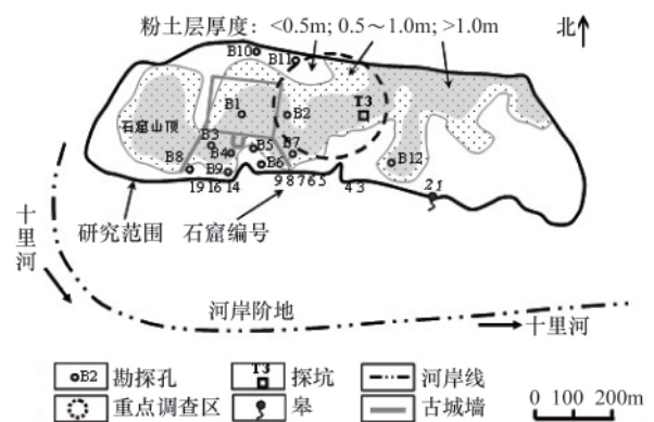
图 1 云冈石窟山体顶部粉土层厚度分布
