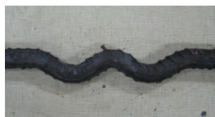
图10 波浪式吸能锚杆的吸能段 Fig. 10 Energy-absorbing segment of a waving energy-absorbing bolt
