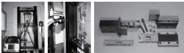
图 1 压缩实验装置及夹具
