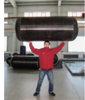
图 7 轻量化复合材料压力容器 Fig. 7 Lightweight pressure vessel
