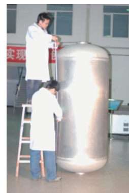
图 8 1500L 超薄铝合金内衬 Fig. 8 1500L ultra thin Al alloy liner
