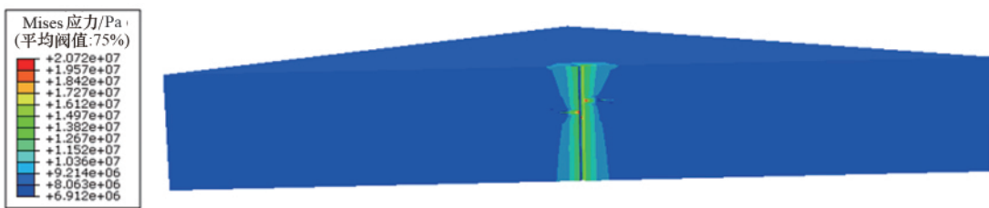
图 5 孔眼根部发生破裂时 Mises 应力云图
