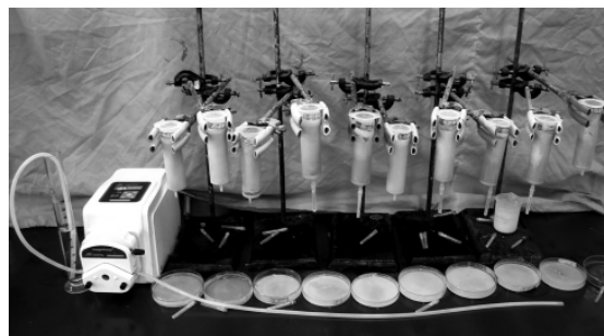
图 2 利用微生物诱导形成碳酸镁胶结松散砂颗粒的试验
