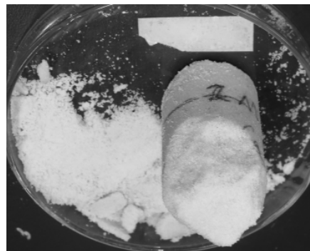
(b) 微生物砂柱的破坏形式 (b) Failure modes of bio-sandstone
