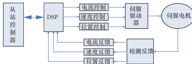
图 3 多轴伺服运动控制系统从站工作原理
