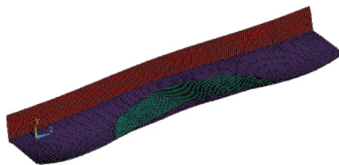
图 11 箱梁底板失稳形态示意图
