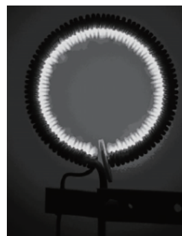
图 4 一种轴对称环形放电器放电图片
