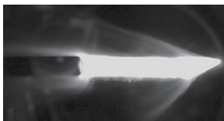
图 3 微波放电等离子体实现丙烷和空气混合物点火
