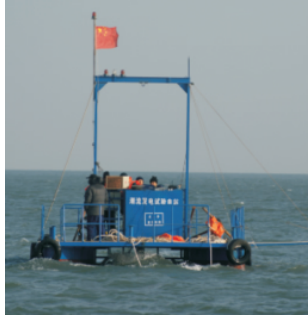
图 5 中国海洋大学漂浮式潮流能发电装置海试图 Fig. 5 Photo of sea test of floating tidal current energy power device on Ocean University of China
