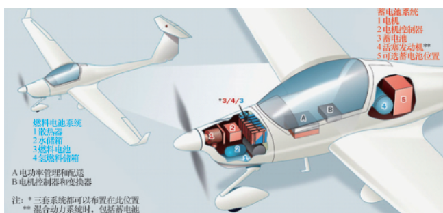
图 9 改装设计的电动飞机布局
