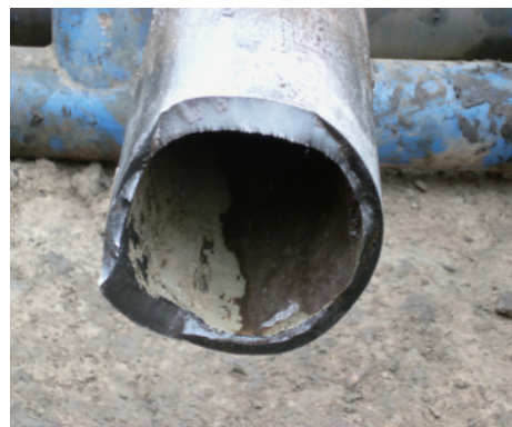
图 1 钻杆氢脆断面
