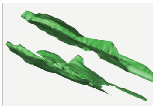
图 5 54-6# 采空区垮塌区域三维实体模型 Fig. 5 Collapse of 3D entity model of the 54-6# cavity
