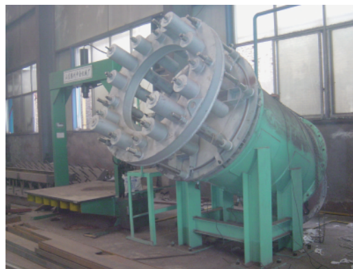
图6 爆炸模拟试验装置
