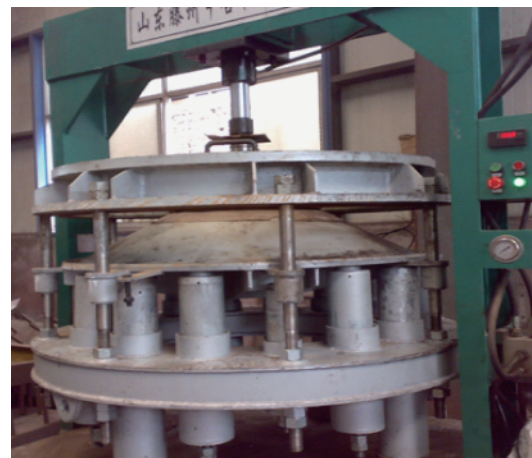
图2 泄爆阀静压试验装置
