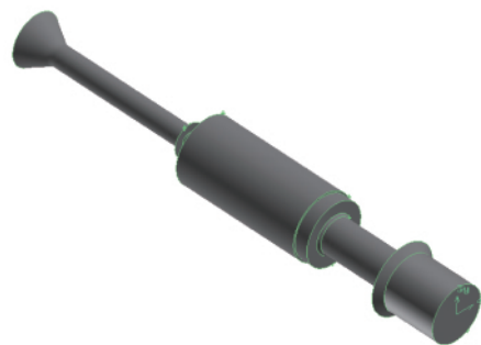
图 2 柱塞泵流体区域三维模型
