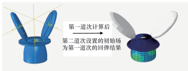
图 1 热旋成形仿真模型
