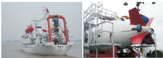
图 13 “向阳红 09”试验母船上的载人潜水器“蛟龙号”(图片来源:中国新闻社阮煜琳)
