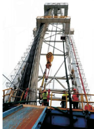
图 15 10000m 超深科学钻探机 (图片来源:中国科学院网站)
