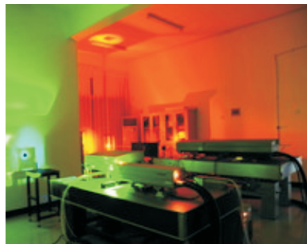
图 16 拉曼激光和钠荧光激光雷达发射单元 (图片来源:武汉大气遥感国家野外科学观测研究站)
