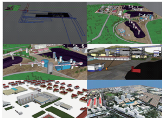
图 7 数字矿山地面、井下三维模型
